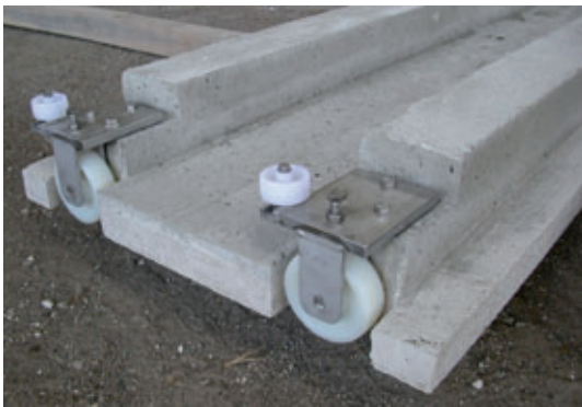
Rollmechanismus der Unterdecke
