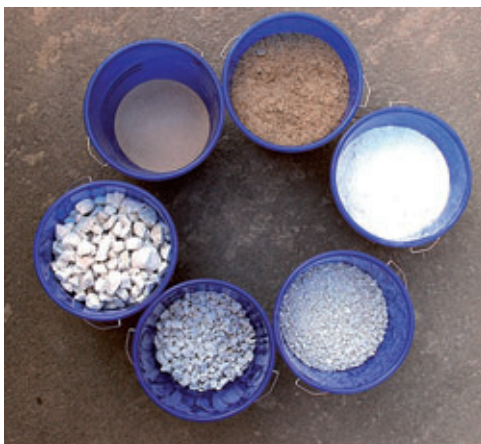
Betonzuschlagstoffe: (1) Weißzement, (2) Marmor 2/8, (3) Marmor 8/16, (4) Marmor 16/35, (5) Quarzsand 0/1, (6) Sand 0/2
